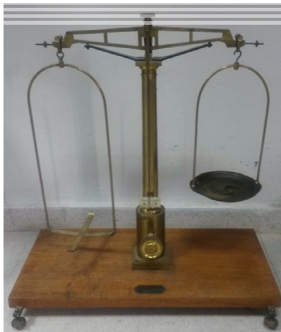
Figura 1. Balanza de Max Kohl. Está incompleta, falta un plato. Esta balanza está fabricada en latón dorado y conserva la cruz, el fiel, la escala, tiene dos platos de diferente altura, uno de ellos puede ser extraído puesto que cuelga de un gancho. Conserva el tornillo de equilibrado original, situado en el cajón justo delante de la cruz.
