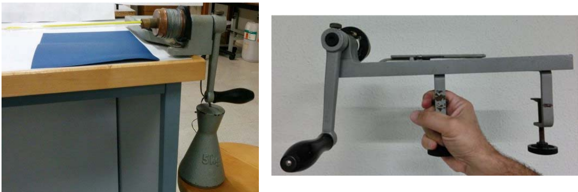
Fig. 1. Equipo experimental para la determinar el equivalente mecánico del calor. A la derecha detalle del instrumento utilizado.
