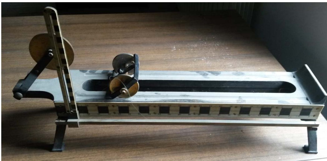
Fig. 3. El plano inclinado didáctico que se conserva similar al del catálogo de Max Khol (Nº51862 Max Kohl p.267). La base se encuentra en buen estado pero no se conservan los pesos del carrito ni de la polea. Un plano inclinado similar se conserva en 4.
