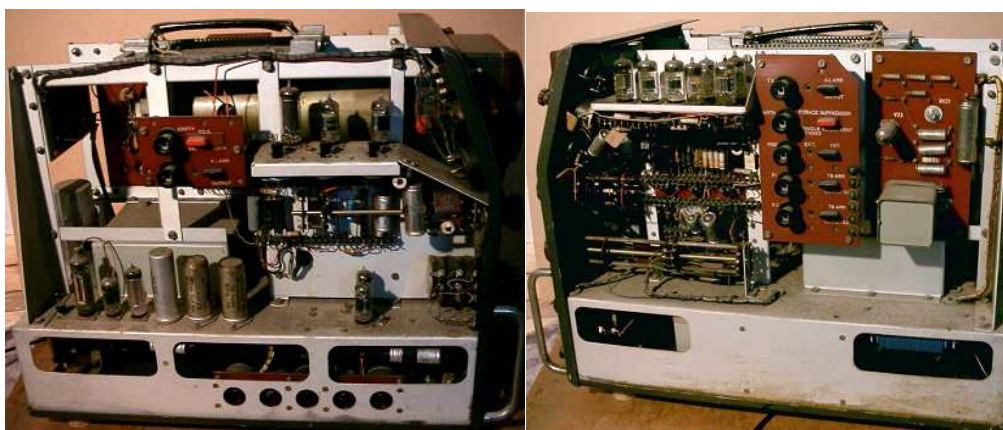
Figura 4. Interior del Oscillograph Cossor 1035. Externamente es similar al Cossor 1049. Sin embargo, a nivel interno, es un modelo muy mejorado que utiliza válvulas de vacío en miniatura lo que se refleja en el rendimiento significativamente mejorada respecto al modelo 1049.
